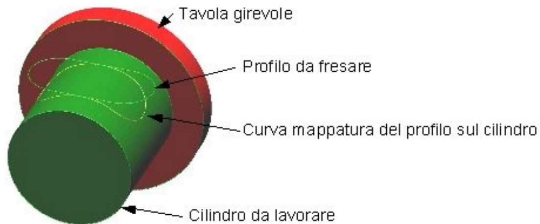
Cilindro dopo la lavorazione
