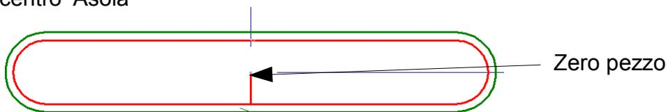
ES 3: Lavorazione esterna di 8 asole B30 (tra i centri) H10 con fresa D4mm con attacco ortogonale.
